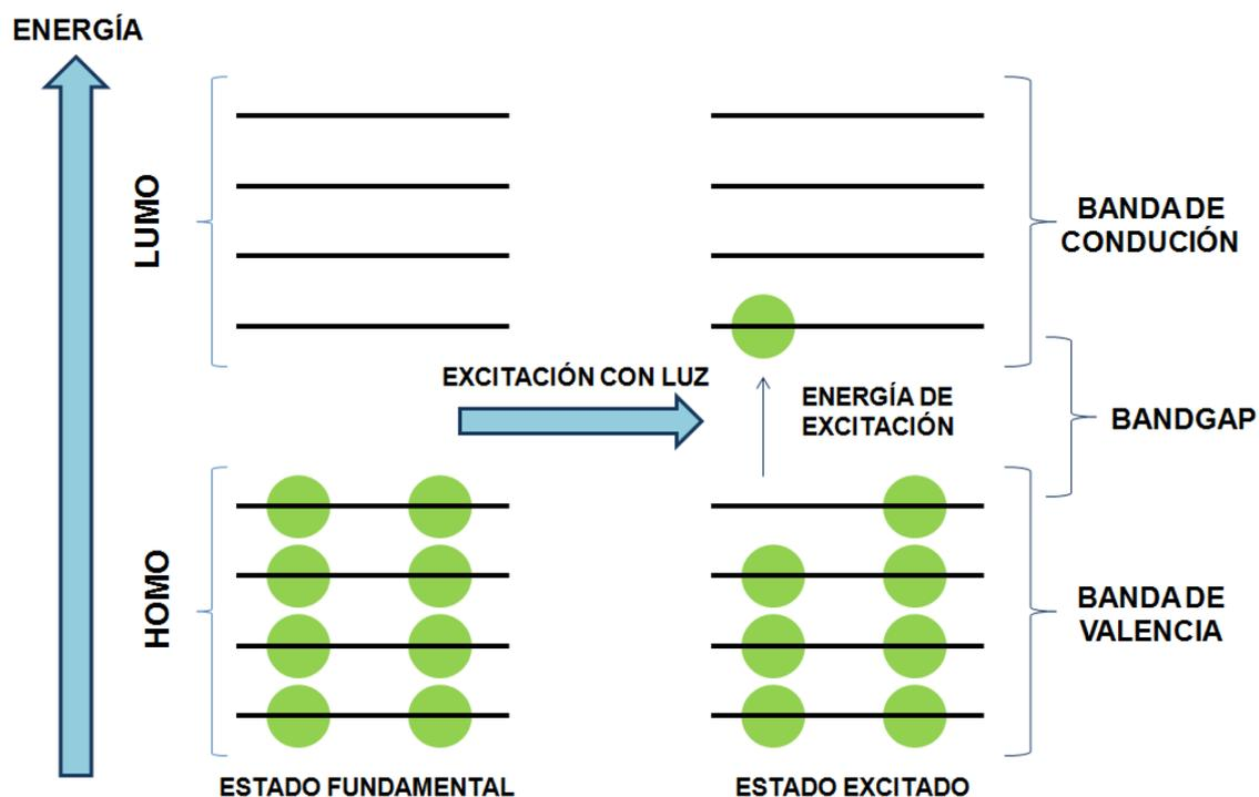
Figura 2: Bandas de conducción y de valencia del semiconductor
